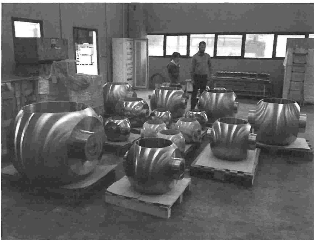
Figuur 9: Onderdelen (kogelafsluiters) voor de nog te installeren veiligheidskleppen gereed voor transport vanuit de fabriek in Italië naar de Boekelermeer
